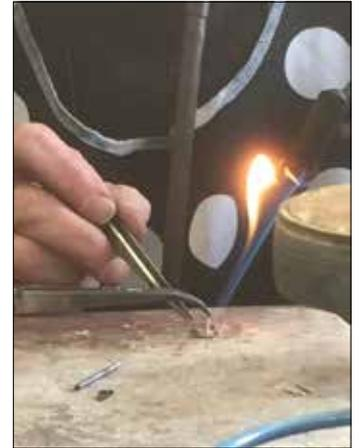
*Ein Pin wird an einen Ohring angelötet.*
