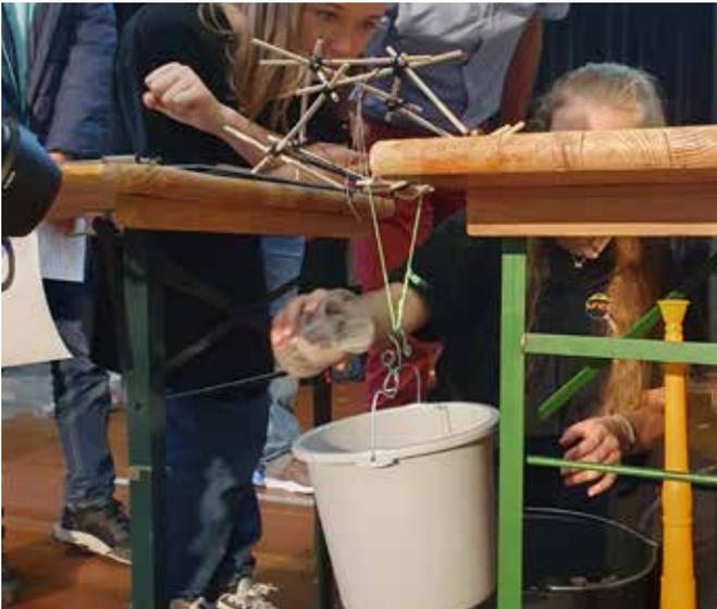
In den Eimer wird Sand gefüllt, um die Brücken kontrolliert zu belasten...
